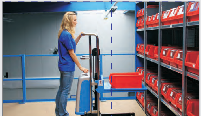
Die elektrischen E-PS0 Hubwagen können mit Plattform oder als Gabelhochhubwagen genutzt werden. So eignen Sie sich perfekt zum Kommissionieren.
