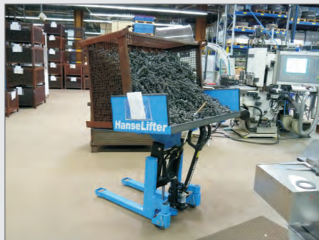
Durch eine Verbreiterung und das Anbringen von Seitenteilen wurde der Neigehubtisch BHN1t für Schüttgut optimiert.
