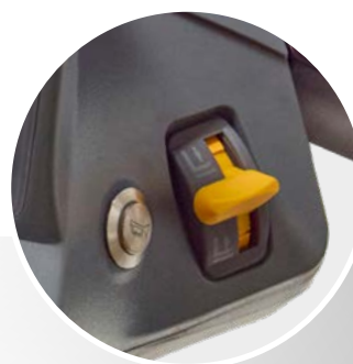
Die separate Hub-Steuerung für fein dosierbares Heben und Senken
