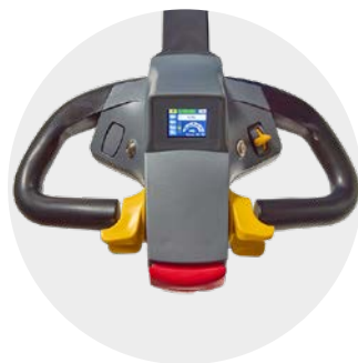
Multifunktionale Deichsel mit einem digitalen Display
