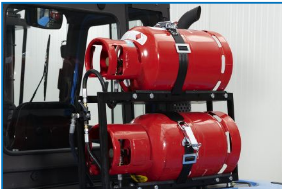
Die Treibgasstapler ab 5.0 Tonnen werden serienmäßig mit einer Doppelflaschen-Halterung ausgestattet. Verschiedene andere Halterungen sind optional erhältlich.
