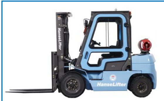
HanseLifter Treibgasstapler mit EU-Vollkabine, für den witterungsunabhängigen Einsatz im Freien.
