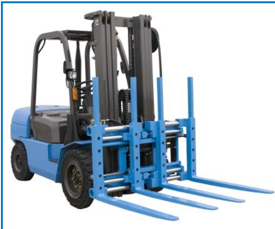
Verschiedene Anbaugeräte, wie z.B. eine Mehrfachpalettengabeln sind für die Gabelstapler erhältlich
