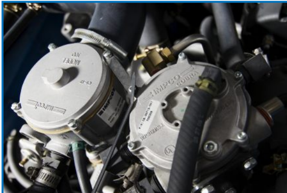
Moderne IMPCO-Cobra Anlagen sorgen für eine optimale Gaszufuhr in den Verbrennungskreislauf.
