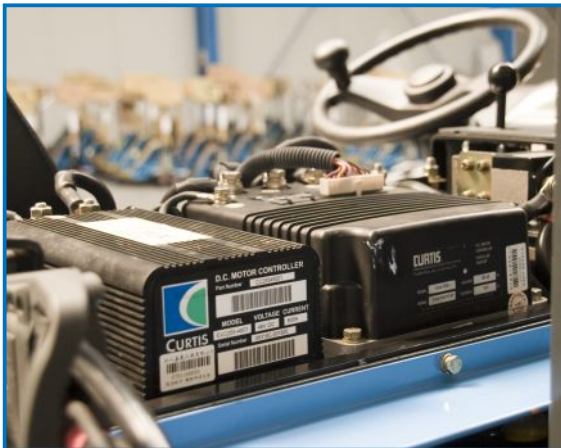
Bewährte CURTIS AC-Technologie und effektive Batterien bilden den Kern der Schubmaststapler.
