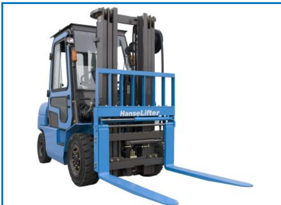
Verschiedene Anbaugeräte, wie z.B. eine Zinkenversteller sind für die Gabelstapler erhältlich
