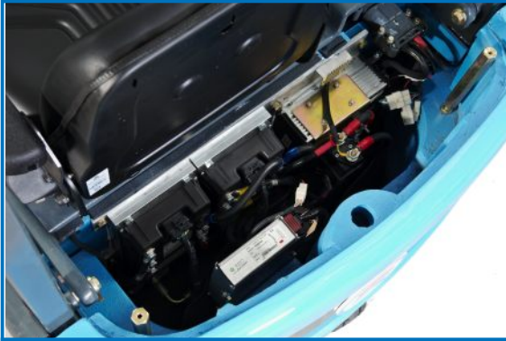
Die Bordelektronik ist leicht zugänglich im Heck des Staplers untergebracht und kontrolliert die Motoren.
