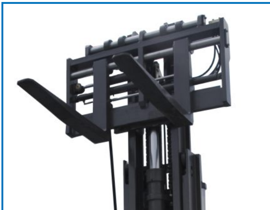
Hochwertige Mastprofile und Gabelträger mit integriertem Zinkenverstellgerät
