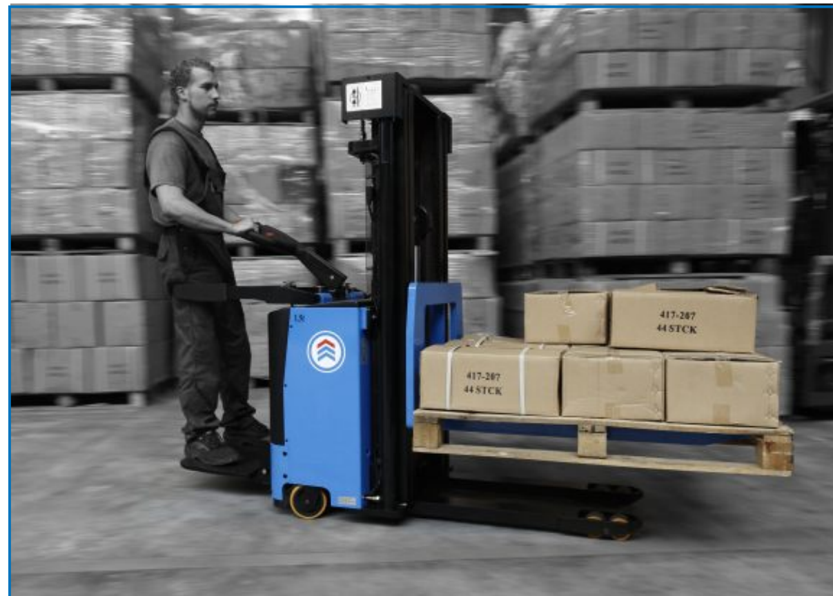
Die Deichselstapler von HanseLifter eignen sich hervorragend für den Transport palletierter Waren über kurze und mittlere Wegstrecken. Die serienmäßige Fahrerplattform und die Seitenbügel sorgen für Sicherheit und Komfort.
